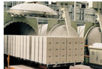
Das Härten der Rohlinge erfolgt in Autoklaven.
