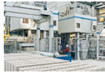
Nach dem Mischen erfolgt das Pressen der Rohlinge
